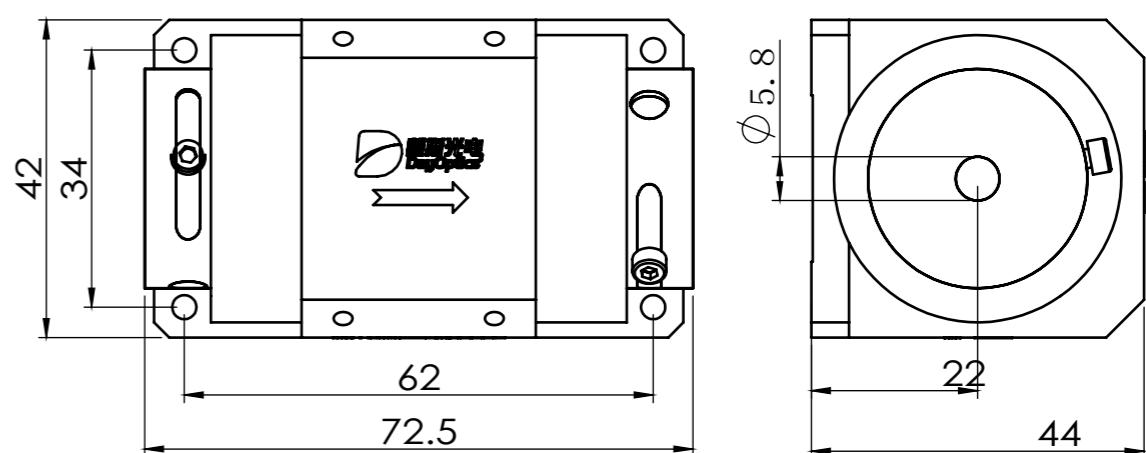
在线隔离器可分为非保偏型在线隔离器和保偏型在线隔离器。是一种能够实现线偏振光稳定传输并保持偏振态不变的激光器件，它主要由偏振分光棱镜、法拉第旋转器和一对准直器耦合组成。
